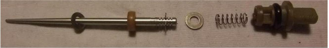
Sur une aiguille il y a dans l'ordre ( en partant de la pointe ) une rondelle métal, une rondelle nylon, un clips ( ici sur la gorge 3 sur 5 possibles ), une rondelle métal, le petit nerveux, le bouchon.
