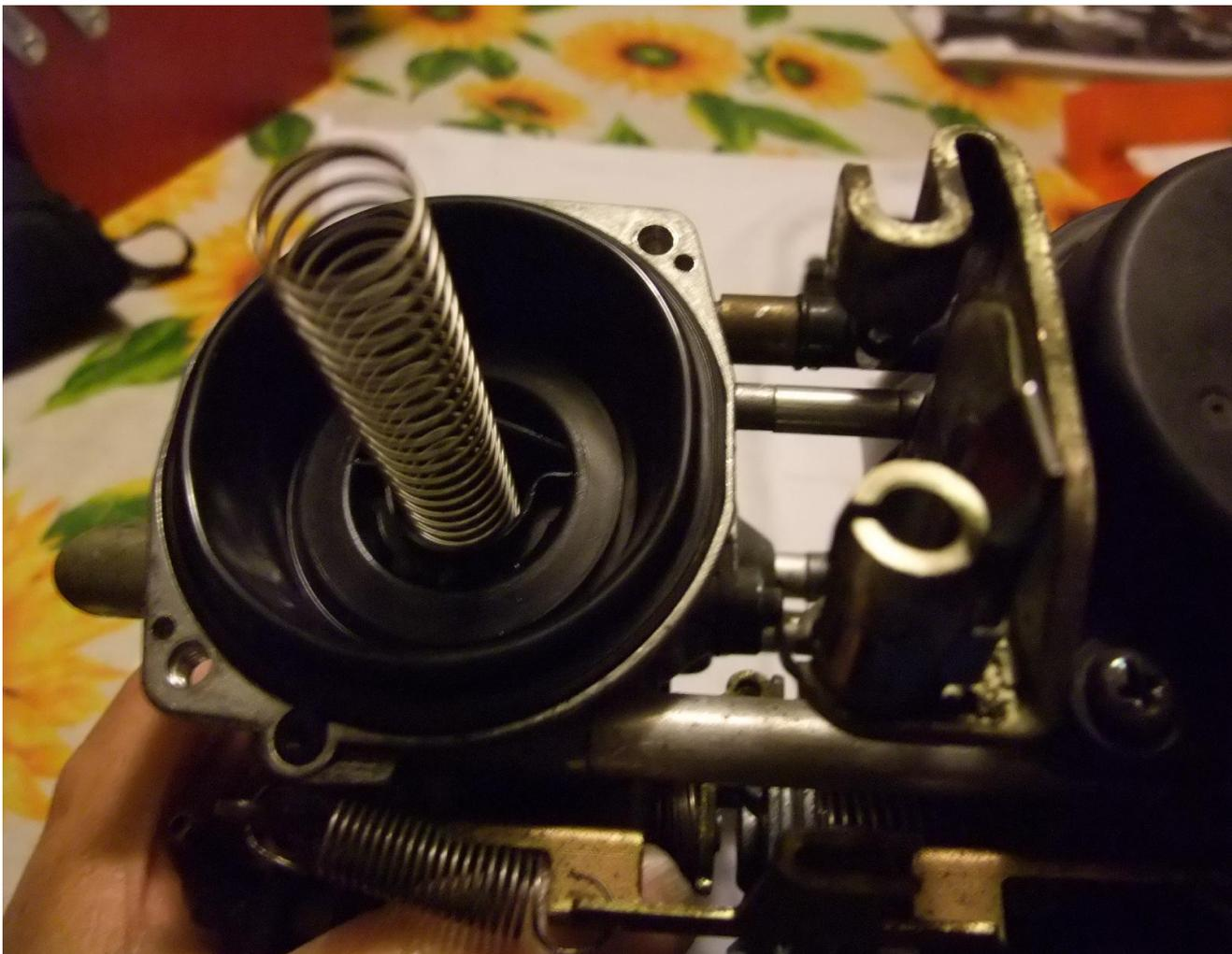
Dévisser les 2 vis ( par carbu ) des capuchons plastiques. J'ai du utiliser le tourne vis à frapper. N'utilisez pas de tourne vis non adapté.
